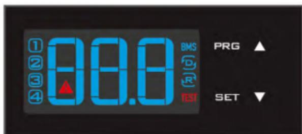
Il display mostra la temperatura nell'intervallo da -50°C a 150°C (da -58°F a 302°F). La temperatura viene visualizzata con una risoluzione di decimi compresa tra -19,9°C e 99,9°C (da -3,8°F a 211,8°F). Durante la programmazione mostra i codici ed i valori dei parametri. Il display mostra anche le icone in base agli eventi che si verificano.
